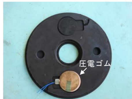
図8 センサ防振ゴムの内部
