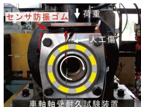
図9 車軸軸受損傷検知の評価試験状況
