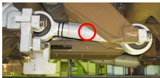
図 2 一本リンクを用いた手法 (赤丸：歪ゲージの施工箇所)
