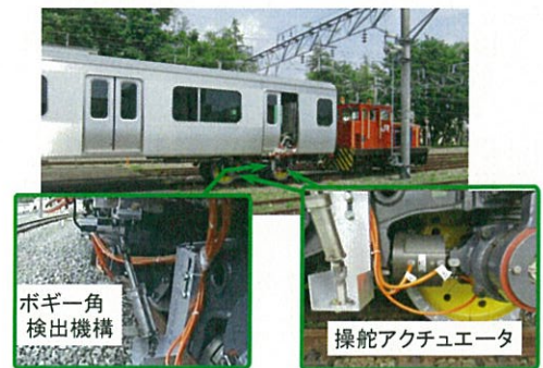
図6 機械式空気圧操舵システム搭載台車
