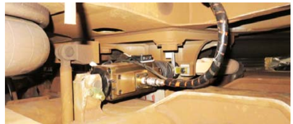
図2 センタリングシリンダー装架状況
