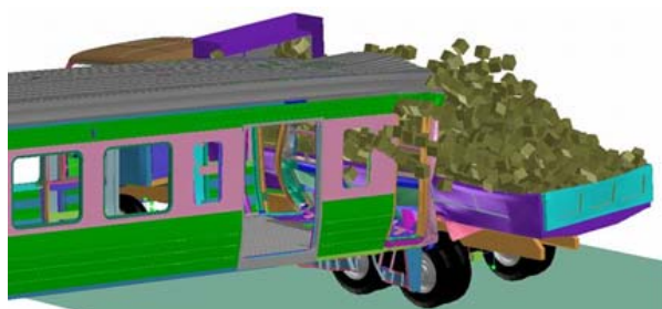
図5 車体の衝突解析例 (54km/h, 衝突後250ms経過)
