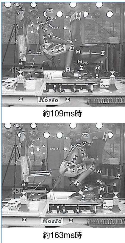
図8 クロスシート着座乗客のスレッド試験(1C条件)
