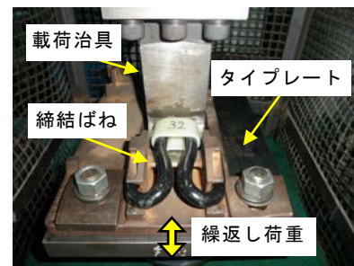
図5 疲労試験の状況
