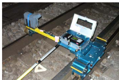
図 4 レール凹凸測定装置
