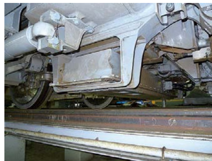
図2 慣性正矢軌道検測装置
