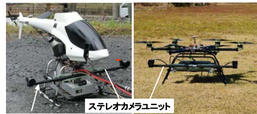
図2 空撮測量システム
