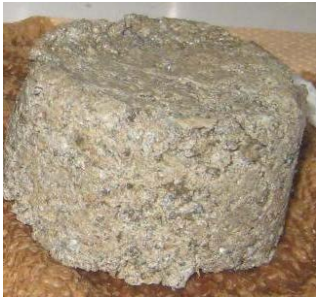
図3 補修材を混合した細粒土混入バラスト
