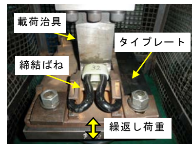
図5 疲労試験の状況
