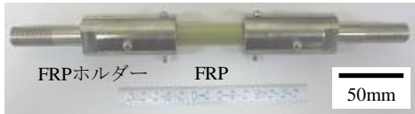
図4 脆性破壊再現試験の試験体
