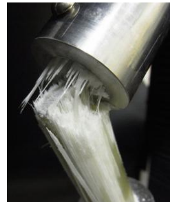
図7 比較品の破壊試験後の状態
