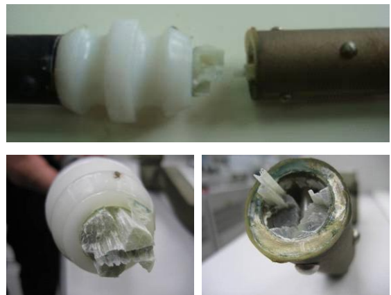
図1 循環電流防止形曲線引金具におけるFRPの脆性破壊例
