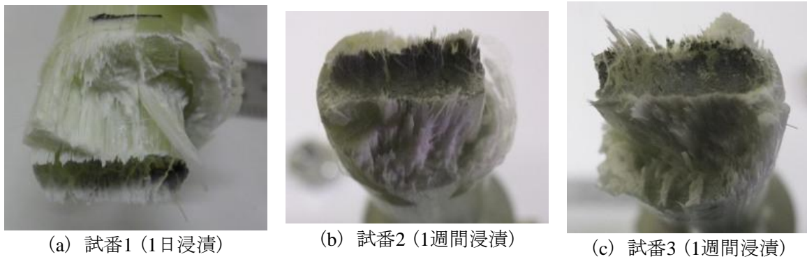
図8 試番1~3(硝酸に浸漬, 荷重無負荷)の破壊試験後の破面
