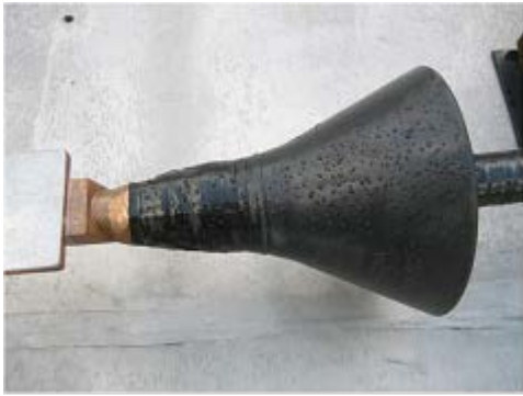
(a) 端末処理に雨覆を付加する手法 (試料 B) (b) 雨天時における絶縁抵抗の経時変化
