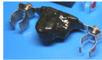
図7 現地模擬地絡試験で使用した試作保護線用素子
