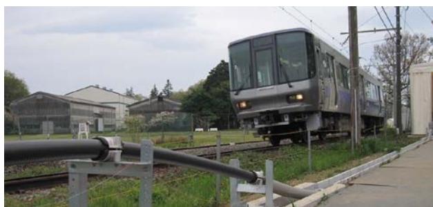
図5 超電導き電ケーブルを用いた電車走行
