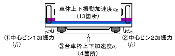
図4 構築する車体モデルの入出力
