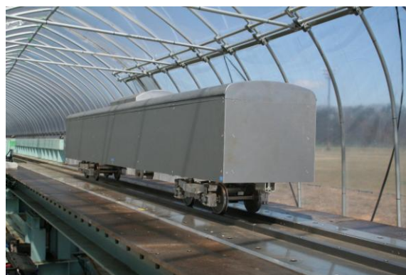
図1 縮尺1/10車両模型
