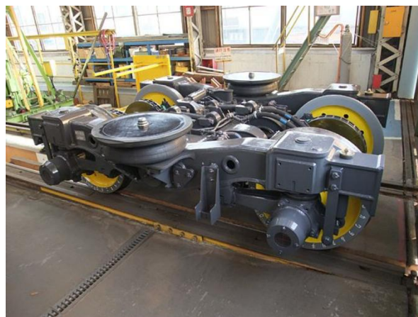
図 1 輪重減少抑制台車の外観
