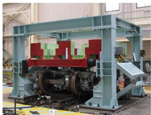
図6 地震時の車両走行安全性評価のための実物台車による加振実験(大型振動試験装置)
