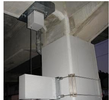
図3 高架橋柱損傷検知装置
