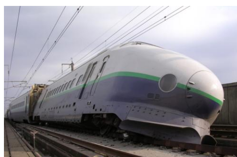
図2 新潟県中越地震による新幹線の脱線
