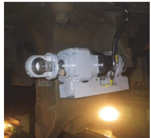
図12 新幹線車両に実装した試作ダンパ
