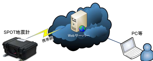
図8 SPOT地震計のネットワーク概念図
