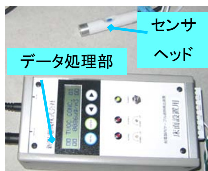
図 3 ケーブル過熱検出装置
