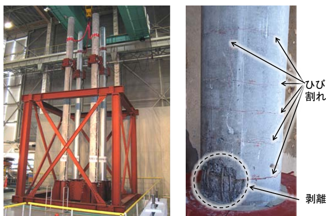
(a)振動台上のコンクリート柱 (b)損傷状態
