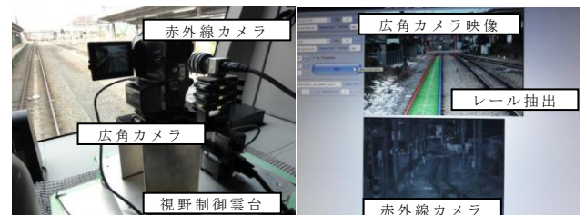
図4 車上測定の様子
