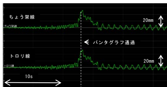
図8 トロリ線およびちょう架線振動波形例 (列車速度：50km/h)
