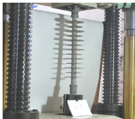
図 9 ポリマーがいしの引張試験
