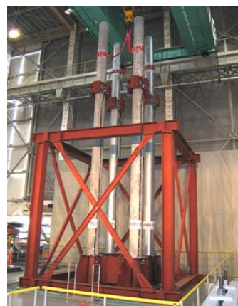
(a)振動台上のコンクリート柱 (b)損傷状態
