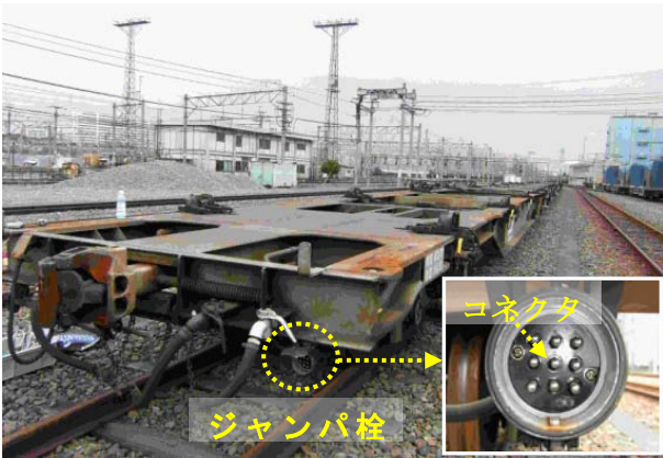
図1 編成貨車端側とジャンパ栓受け
