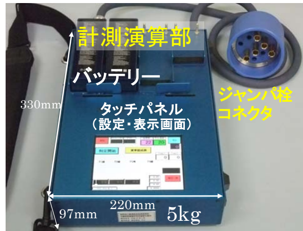
図 7 断線箇所特定装置（可搬型）
