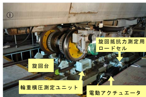
図1 台車旋回性能試験装置での試験の様子
