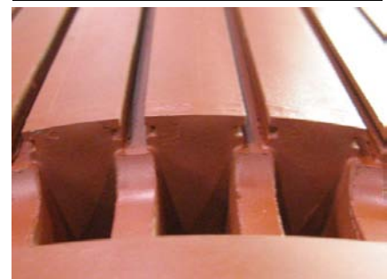
図2 試作機の回転子スロット部
