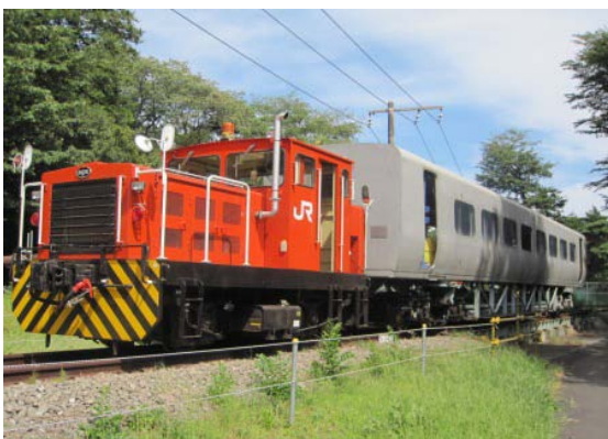
図 4 走行試験状況（機関車＋試験車両）
