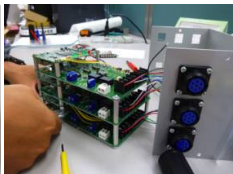
図 2 : データロガー (基盤構成)
