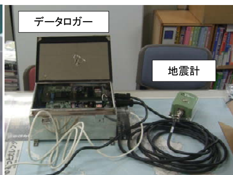
図 3 : 地震計・データロガーの概要
