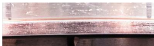
図 5 試験後の模擬トロリ線表面
