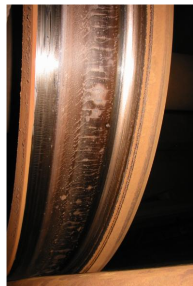
図 1 実車の車輪踏面熱き裂
