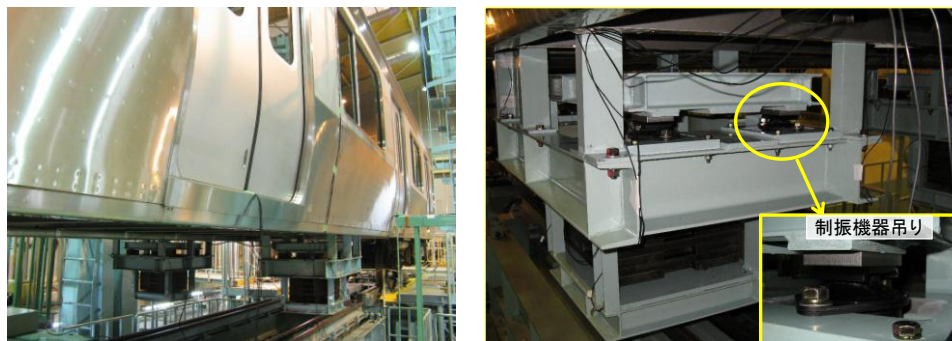
(a) ダミー機器設置状況 (b) ダミー機器 (質量 500kg/片側)
