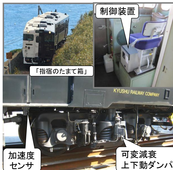
図10 観光特急「指宿のたまて箱」に搭載された可変減衰上下動ダンパと加速度センサ
