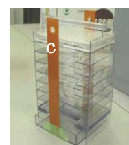
図1 細胞用中間周波磁界曝露装置 a. 曝露用培養器, b. 曝露用コイル, c. 生物試料保持用ラック
