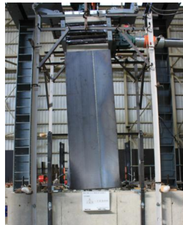
図 2 載荷試験の例（鋼板巻立て補強試験体）
