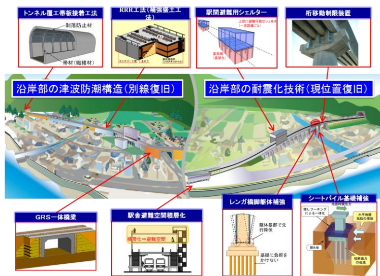
図4 沿岸部津波被害地区における復旧・復興技術
