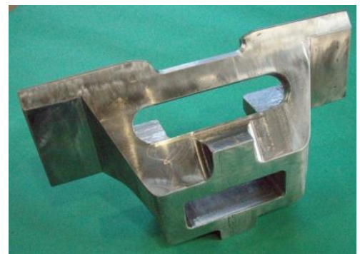
図3 試作したレール応急処置器
