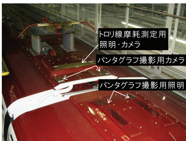
図2 800系U8編成に搭載の架線検測装置
