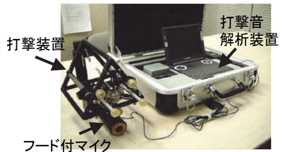
図 3 総研式打音検査装置
