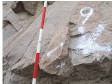
図5 不安定岩塊の例
