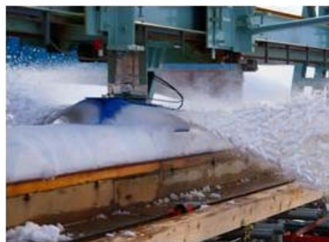
図2 模型スノープラウによる排雪抵抗力評価試験
