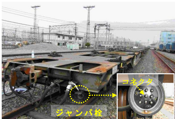
図1 編成貨車端側とジャンパ栓受け
