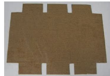
図 7 開発した PBO 繊維による高放熱接着シート
