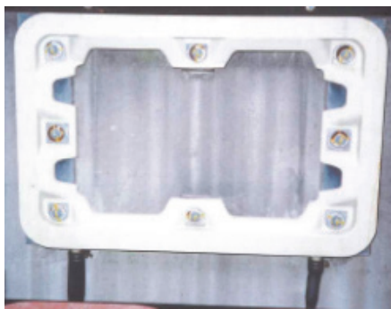
図 6 宮崎実験線推進コイル
