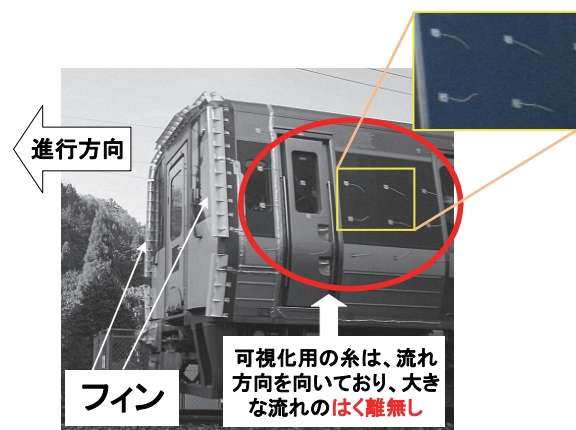
図10 在来線先頭車両の空力特性改善に関する走行試験
