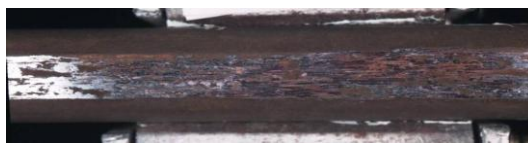
図6 供試すり板使用前後のトロリ線しゅう動面の状況の変化 (低速力行区間)
