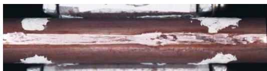
図6 供試すり板使用前後のトロリ線しゅう動面の状況の変化 (低速力行区間)
