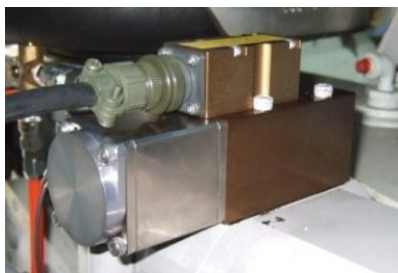
図2 応答性を向上する流量制御弁
