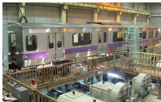
図3 車両試験台での加振試験
